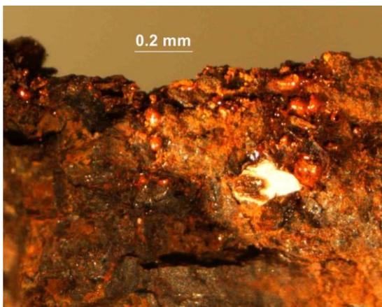
*Figure 7. Nail 0014/4: corrosion pustules.*
